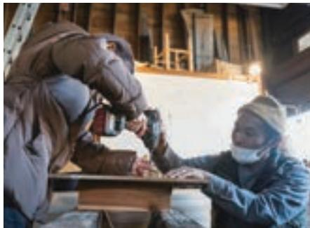
工具の基本的な使い方を学ぶ。電動とはいえ、ビスを打ち込む際にドライバーがブレないようにしたり、ボタンを押す指の加減が必要だったり、思った以上に「手の力」が問われる
